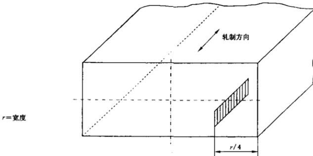
图6 厚度 $> 50$  mm钢板的取样
