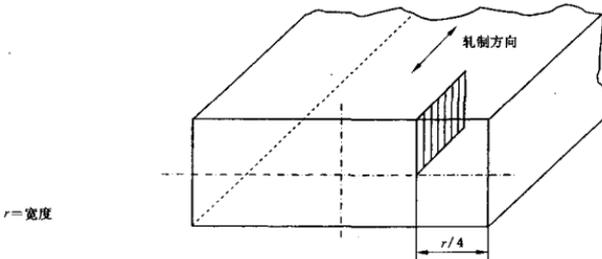
图5 厚度 $> 25$  mm~50 mm钢板的取样
