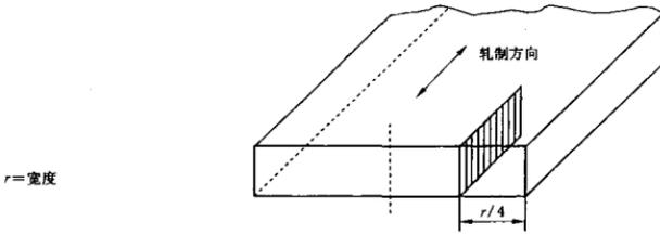
图4 厚度 $\leq 25$  mm钢板的取样
